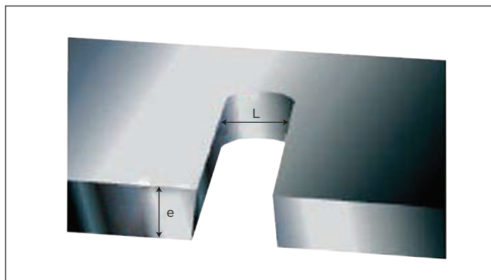
Соотношение между площадью стенок трафарета и площадью контактной площадки
